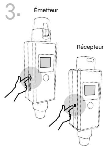
Appuyer sur le bouton d'alimentation. Allumer l'émetteur et le récepteur. L'écran LED s'allumera et affichera la fréquence des deux éléments pour vérifier qu'elles sont identiques.
