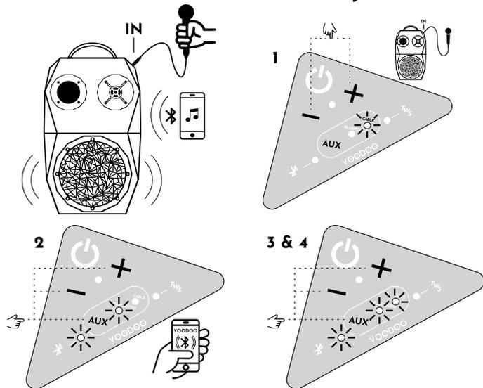
Il est possible de raccorder un micro avec un câble mini-jack et de connecter en même temps un appareil mobile en connexion Bluetooth. Attention les réglages sonores doivent se faire lors de la configuration de vos appareils.
