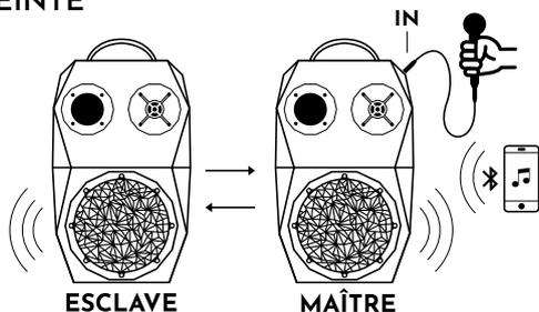
Branchez un micro sur une des deux enceintes et connectez le reste du dispositif en stéréo.
