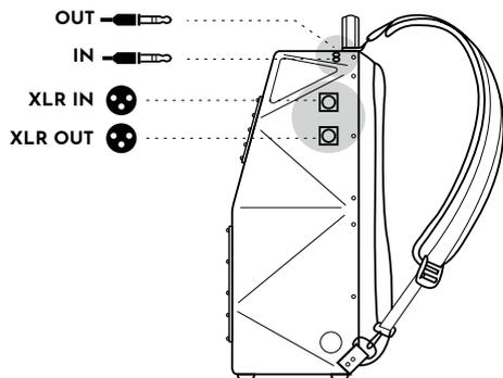
L'enceinte dispose de deux entrées/sorties par câble via prise XLR ou Mini-Jack.
